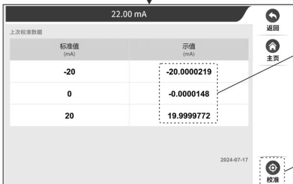
进入校准点界面后，点击【下一步】开始校准，标准值是提供的标准输入值，示值是CC30实际显示值，点击当前校准的标准值可以修改标准值。点击界面上【下一点】校准下一点，全部校准完成点击【保存】完成校准流程。
