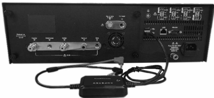
注：通过控制器后面板的 USB 接口连接一台 CC30。
