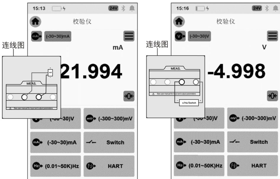
在校验仪页面将测量档位切换至 HART, 校验仪将自动用上一次选择的供电配置 (默认为内电源内电阻连接方式), 并对“0”地址进行搜索。搜索到 HART 设备后自动连接并显示其示值。如果连接不上 HART, 请按以下方式手动搜索 HART 设备, 图示以【内电源内电阻模式】的连接模式为例。
